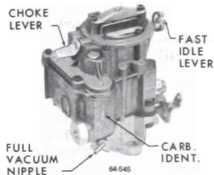
Figure 64-53A - Rochester MV Monojet Carburetor
